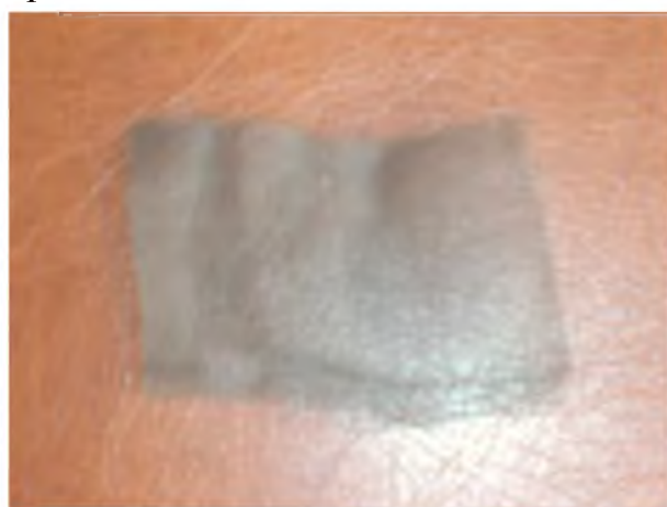
Рис. 1. Тонкопрофильная ткань из никелида титана
