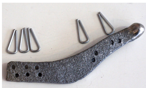
Рис. 4. Пористый эндопротез с фиксирующими элементами с памятью формы из никелида титана
