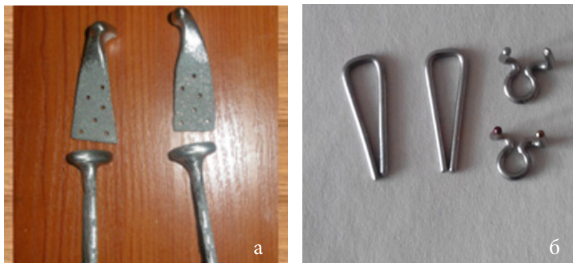
Рис. 1. а – эндопротез головки и ветви нижней челюсти на основе никелида титана (правый и левый варианты); б – термомеханические фиксирующие элементы с памятью формы
